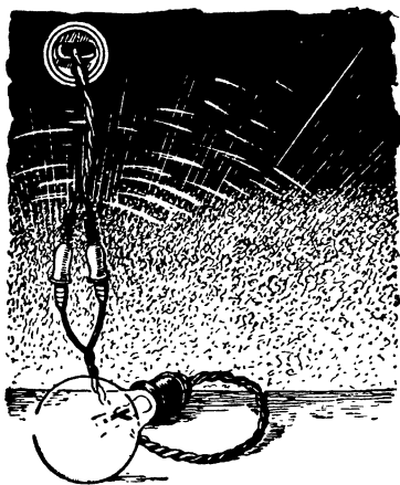
Рис. 45. Испытание соединительного шнура при помощи контрольной лампочки.
