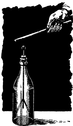
Рис. 2. Простейший электроскоп.
